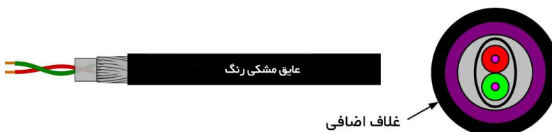
شکل ۳-۰: شمای ظاهری کابل‌های زیرزمینی پروفی باس
